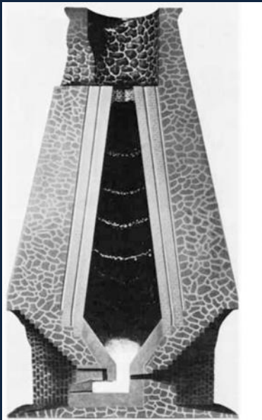
Şekil 265 1796'da Gleiwitz'da/Yukarı Silezia'da inşa edilmiş ilk Alman kok yüksek fırını
