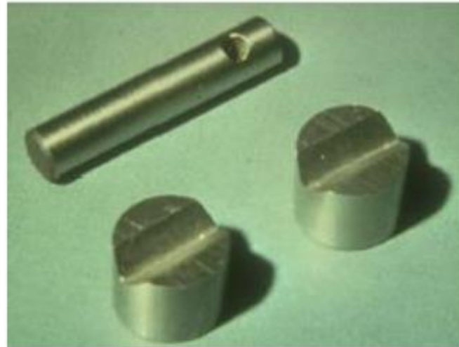
Şekil 4.3 Pin & V Block test cihazı standart pim ve V bloğu numuneleri |
